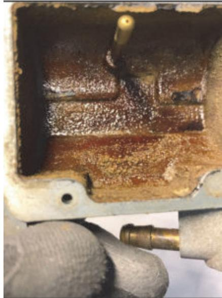
Durch verschiedene Zusätze beim Ultraschallbad konnten die Ablagerungen bis auf die in der 035er Düse beseitigt werden, somit sollte der Vergaser wieder einwandfrei funktionieren.
