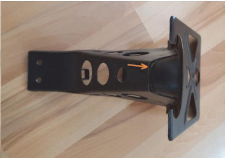
Das Original hat am Oberteil eine "Umbiegung" zu dem becherförmigen Teil hin, an dem das Rücklichtglas befestigt wird.
