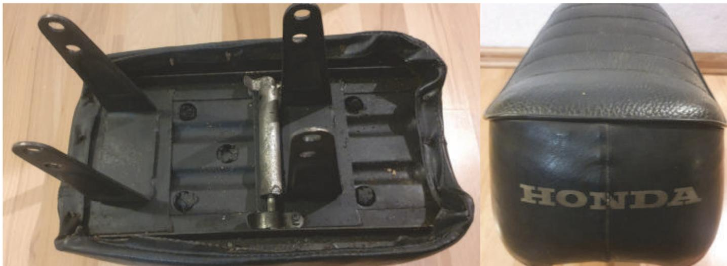
Sitzbank von unten, mit Bordwerkzeug, und von hinten mit Naht durch den Buchstaben "N".
