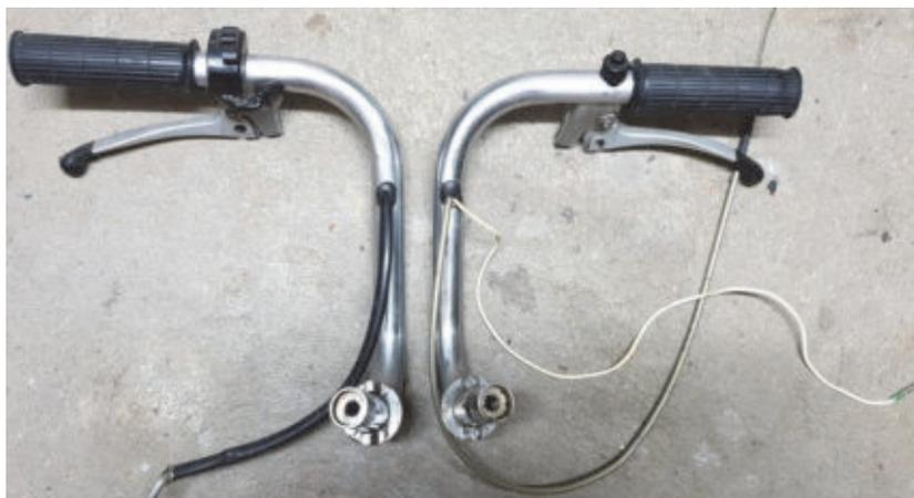
Z50A Lenker mit Kabeldurchführungen frontal, zwei Bremsgriffen und links und rechts Armatur-Aufnahmen (und entsprechend den Löchern dafür im Lenker).
