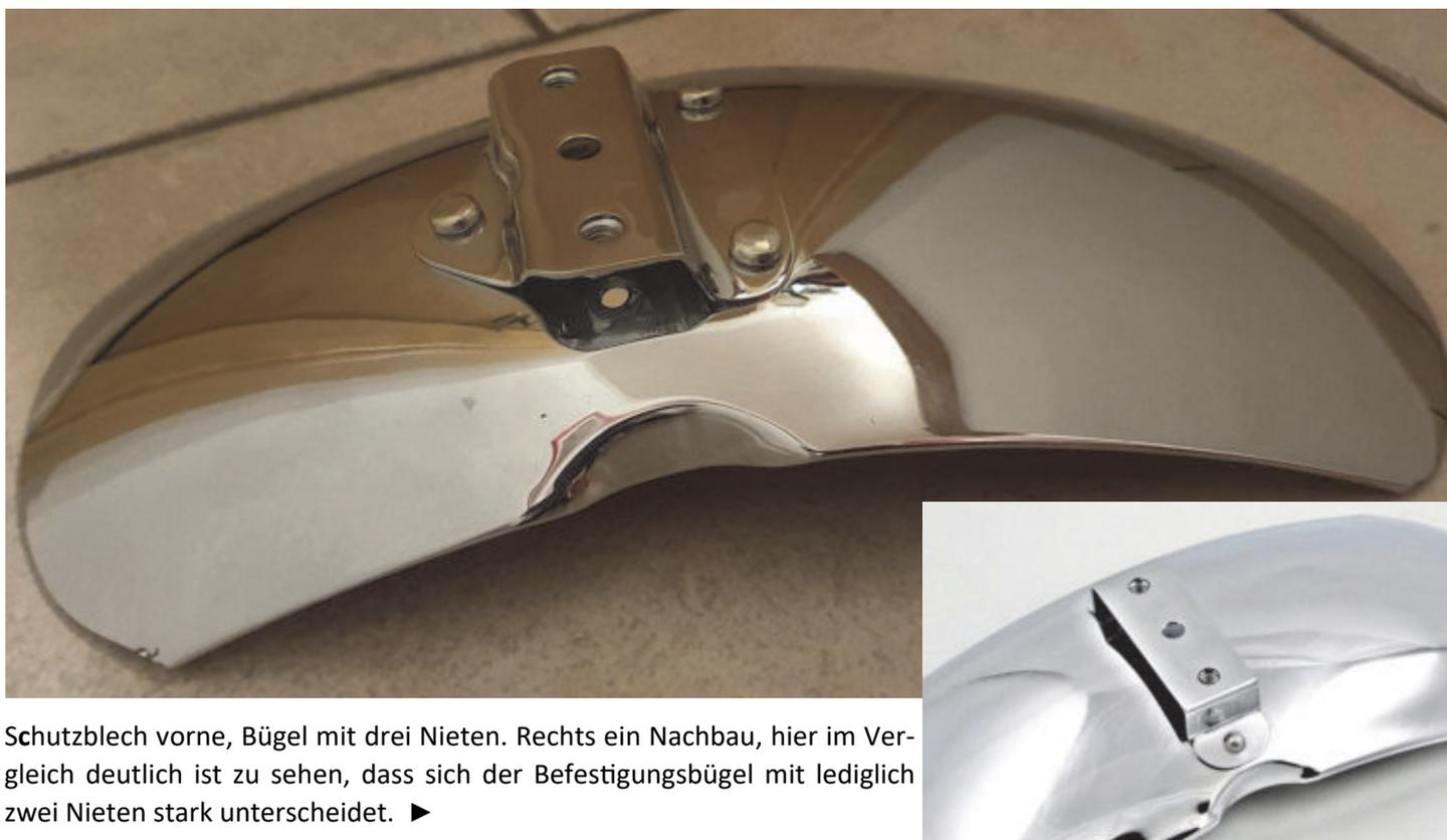
Schutzblech vorne, Bügel mit drei Nieten. Rechts ein Nachbau, hier im Vergleich deutlich ist zu sehen, dass sich der Befestigungsbügel mit lediglich zwei Nieten stark unterscheidet. ►
