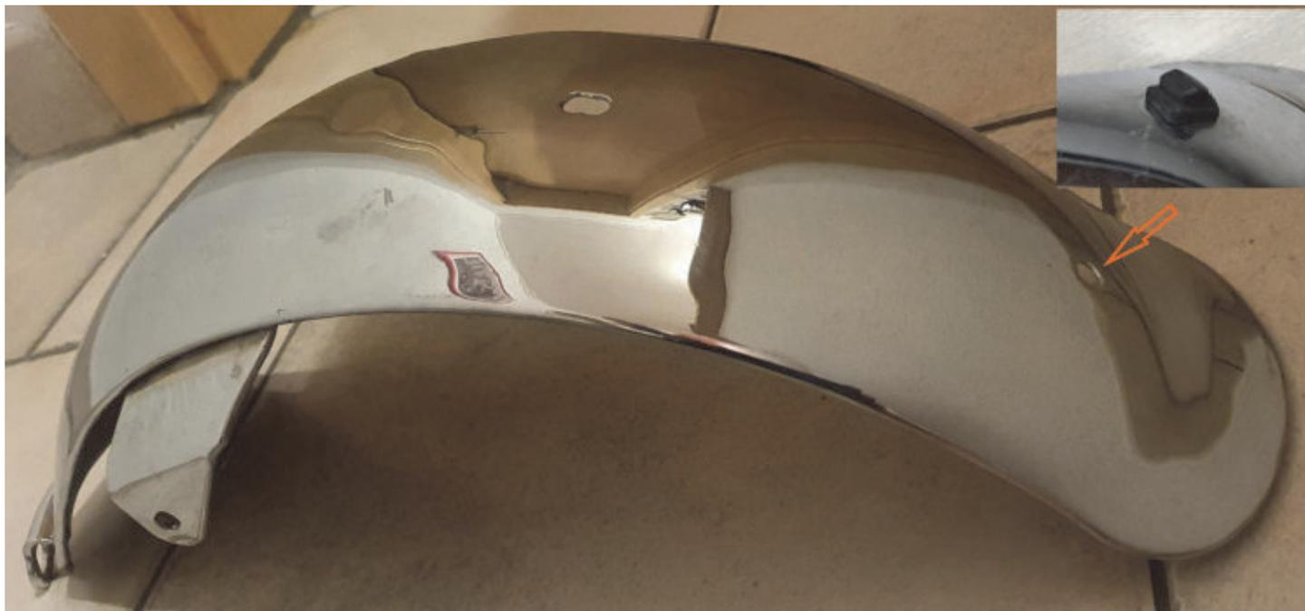
Schutzblech hinten, langer Auslauf, mit Loch (Pfeil) für Gummipuffer.
