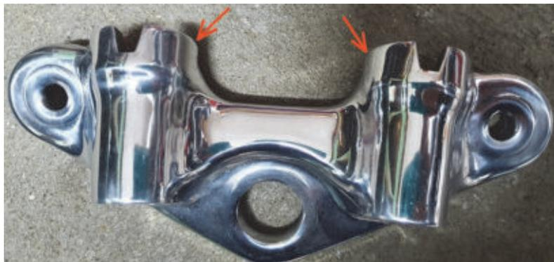
Bild oben links mit Arretier-Kerben, im Bild rechts (polierte Brücke, so nicht original) aber halt ohne die Kerben.
