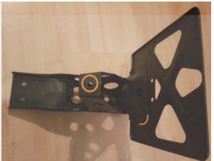
Am Fußpunkt zum Schutzblech ist beim HONDA Teil eine deutlich größere Bohrung, in die ein Puffergummi gehört. ►
