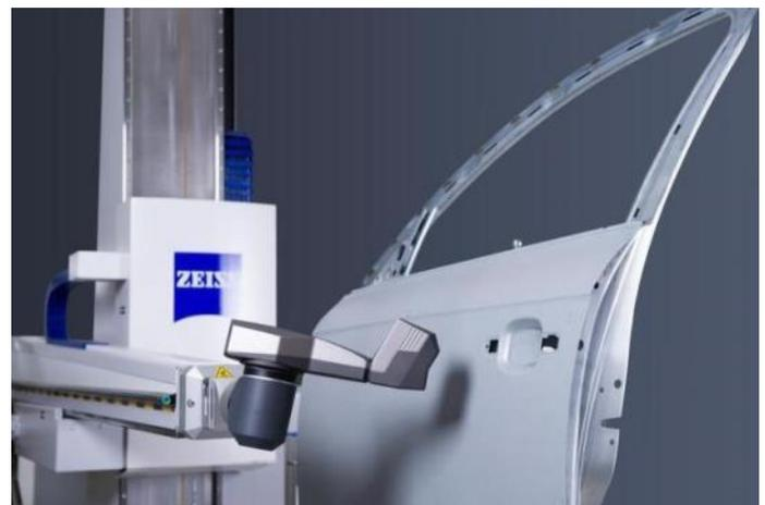
Abbildung 3: 3D-Laserscanner an einem Horizontalarm-Koordinatenmessgerät
