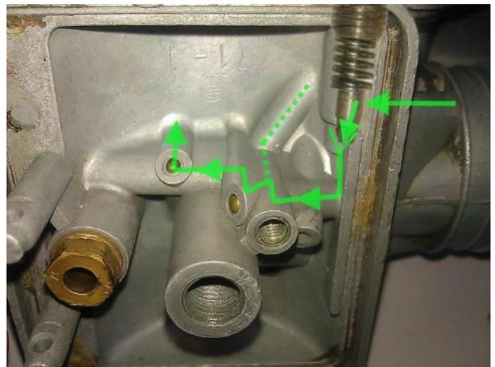
Verlauf der angesaugten Luft für den Leerlauf
