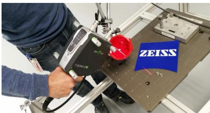
Abbildung 5: Die Scannerpistole im Einsatz: in den zylindrischen Auswüchsen an der Pistole befinden sich die Marker, welche der Tracker "sieht" und daraus die Position und Ausrichtung der Pistole berechnet. Die Pistole selbst enthält den Linienprojektor und die Kamera und stellt die "Laser Triangulationseinheit" dar. Sorry für das Mauspad mit der "Werbung". Hier wird gerade eine Honda CZ100 "Mark 2" Lampe (Modell 1964 – 1966) gescannt.
