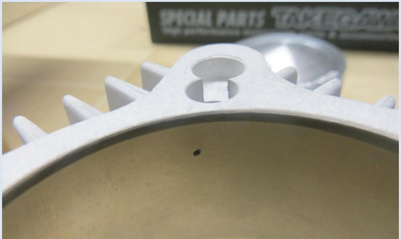
Bild 7: Damit der hochdrehende Motor optimal geölt wird, haben die Take-Techniker den Zylinder im Ölsteigkanal mit einer Bohrung versehen, wodurch der Kolbenbolzen eine Extraportion Öl bekommt.
