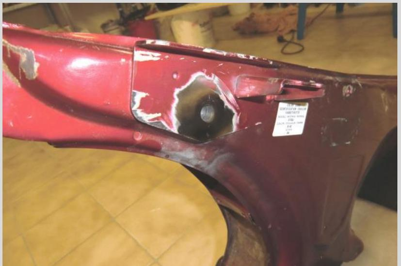
Anschließend mittels Stufenbohrer die Welle auf 15 mm ausbohren – am besten einen Stufenbohrer nehmen, der nicht größer als 15 mm ist – somit kann nicht versehentlich größer gebohrt werden. Jetzt müsste die Achse schon fast lose sein: Mittels Zange etwas drehen und die Reste aus dem Rahmen ziehen.
