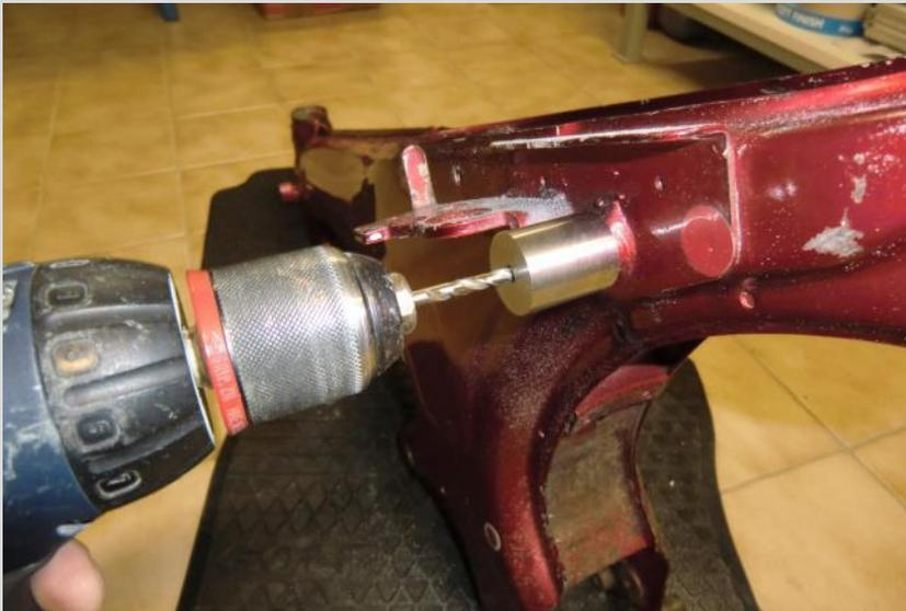
Dann zuerst die Lehre mit dem 5er Loch aufstecken und ca. 3 cm – 4 cm tief bohren – danach das Gleiche mit der großen Lehre mit dem 10er Loch ausbohren.
