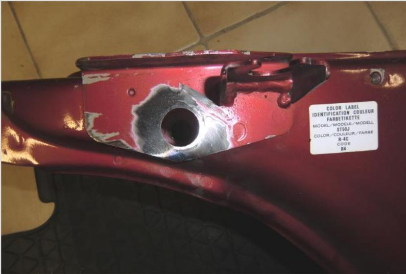
Zum Schluss nur noch etwas entgraten und die neue Stoßdämpferachse in die gebohrten Löcher führen und einschweißen oder einschweißen lassen.
