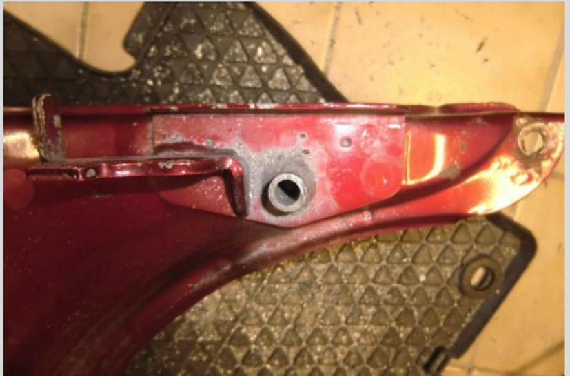
Jetzt den Überstand der Achse bündig mit dem Rahmen abschneiden.
