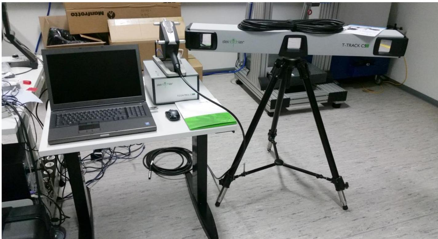
Abbildung 4: v.l.n.r.: PC, Steuerbox, auf der Steuerbox stehend die Scanner"pistole" (Messkopf) und daneben der Tracker-Balken
