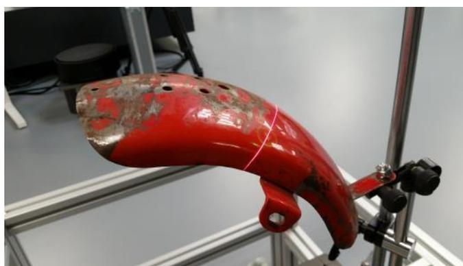
Abbildung 6: Scanning eines Honda CZ100 "Mark 2" Vorderradschutzbleches
