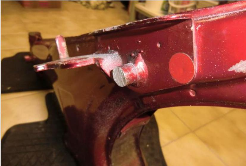
Zuerst die alte Achse links und rechts mit ca. 1,5 cm – 2 cm Überstand vom Rahmen abschneiden.
