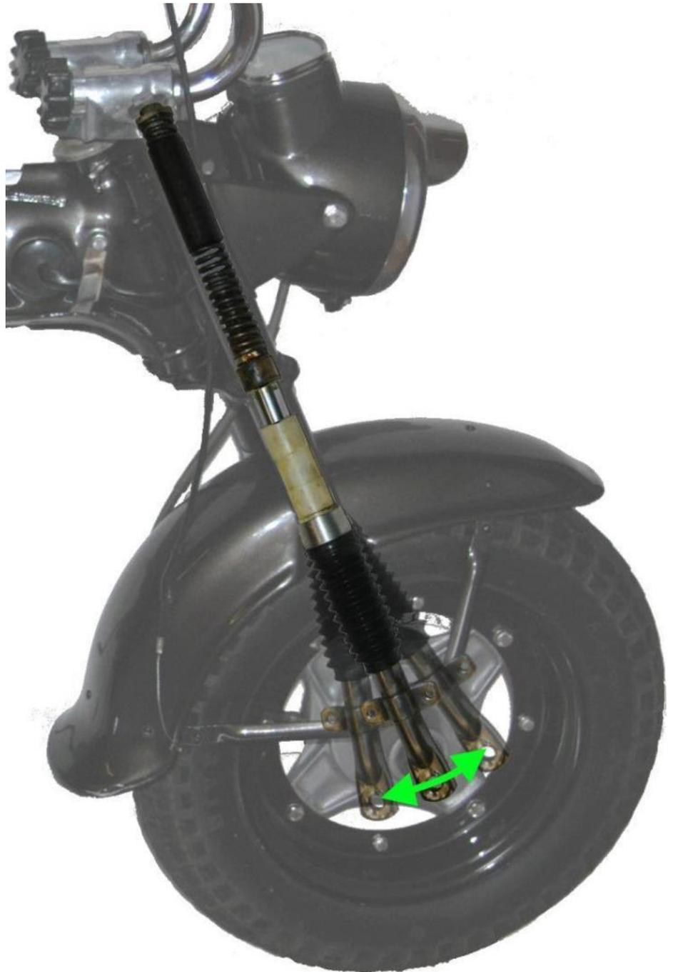
und das Vorderrad ausbauen. Nun noch das Schutzblech entfernen und die oberen Schrauben vollständig herausdrehen.
