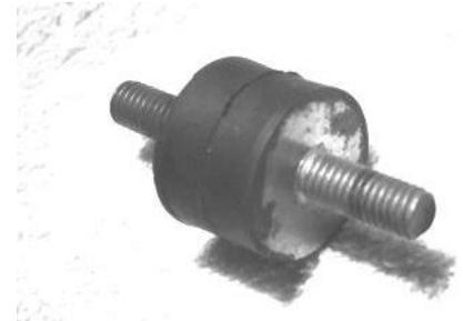
Dies schien mir das geeignete Objekt für mein Vorhaben zu sein. Kurz mal ausgemessen, wie „dick“ der Gummi sein muss, damit er „spack“ zwischen Schutzblech und Kennzeichen-träger passt: 7mm. Also kurzerhand das Teil locker in die im Schraubstock festgeklemmte Bohrmaschine eingespannt und bei kleiner Drehzahl vorsichtig(!) mittels Messer sauber durchgeschnitten.
